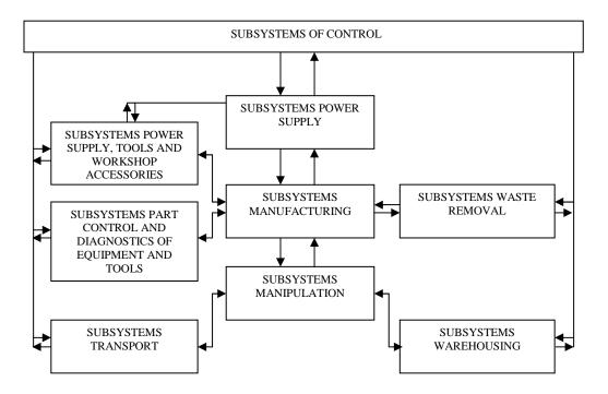
Fig. 1. The structure of a flexible manufacturing system in the systemic approach Source: Figure modified based on Brzeziński Marek: Organizacja produkcji w przedsiębiorstwie. Wyd. Difin SA, Warszawa 2013.
